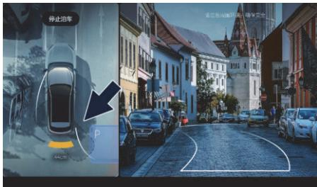
3. 图中阴影小车为下一步车辆停车位置。如您发现阴影小车位于其它障碍物上，且车辆靠近时仍无停车，请务必注意及时接管车辆。
