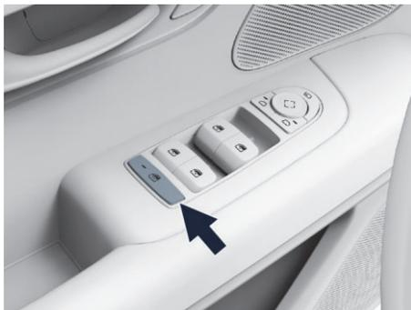
图示：车窗锁止开关
