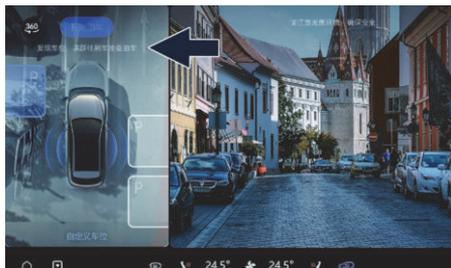
1. 开启 APA 后，请您控制车辆低速前进（速度小于 25km/h）以搜索车位。当搜索到车位时，中控屏会出现蓝色或白色停车框。踩下制动踏板停止车辆，选择需要停入的车位后，“开始泊车”开关变蓝。
