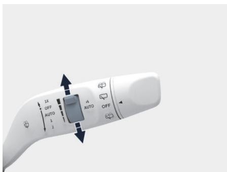
图示：上下拨动拨杆，调节雨刮灵敏度
