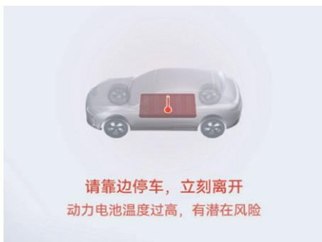
图示：仪表显示屏动力电池过温警示（不同版本存在差异，请以实车为准）
