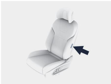
图示：前排座椅侧气囊位置
