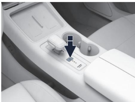
图示：P挡关闭车辆（换挡操纵杆形状请以实车为准）
