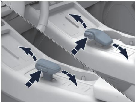
图示：换挡操纵杆（左侧为水晶挡杆，右侧为游艇挡杆）
