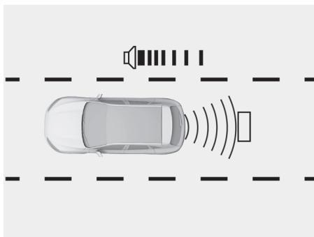
车辆启动后，您将换挡操纵杆置于倒车挡（R挡）进行倒车时，前、后雷达将自动启用。
