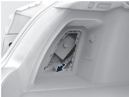
图示：充电枪应急解锁拉线
