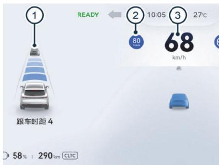
图示：仪表显示屏 ACC 设定车速（不同版本存在差异，请以实车为准）
