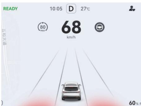
图示：盲点检测系统/并线辅助警示图标
