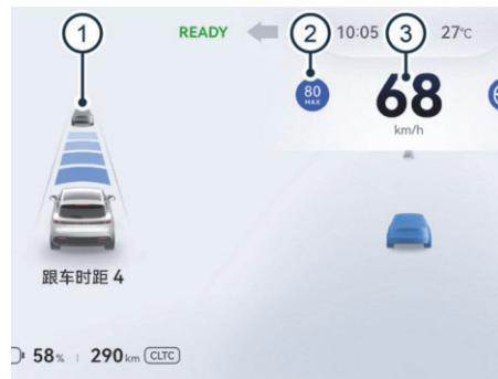
图示：仪表显示屏ACC设定车速（不同版本存在差异，请以实车为准）
