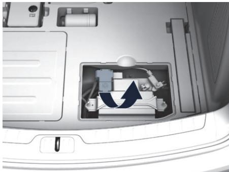
图示：低压蓄电池正极端子保护盖
