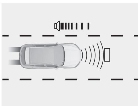
车辆启动后，档位在D/N档，且车速在15km/h以下时，前雷达自动启用。在靠近障碍物时发出声音警告信号。
