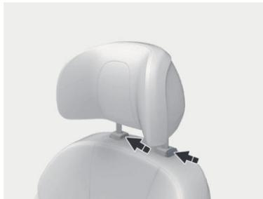
图示：拆卸副驾驶座椅头枕
