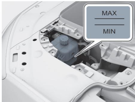
图示：驱动电机冷却液罐
