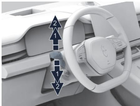
图示：拨动拨杆，开启转向信号灯
