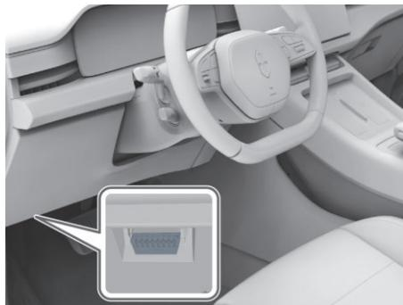
图示：OBD诊断接口位于驾驶员侧仪表板左下方
