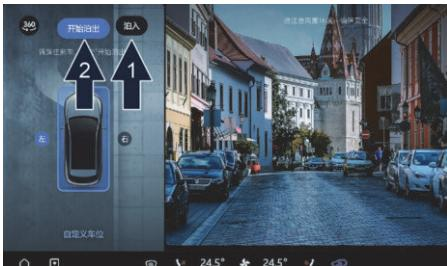
1. 开启 APA，踩住制动踏板，在车辆静止状态下点右上角“泊入/泊出”切换至泊出模式（泊出模式时图标显示文字为泊出），选择泊出方向后，点击“开始泊出”，开启辅助泊出功能。
