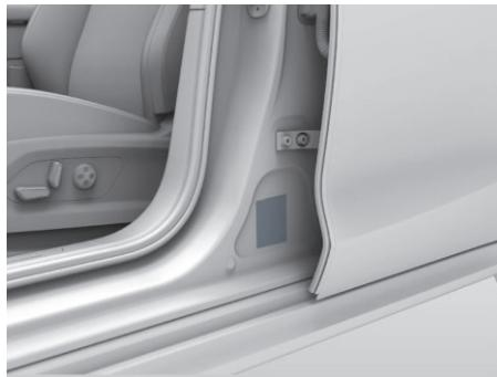
图示：胎压标签位于左侧B柱下方
