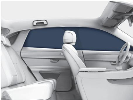
图示：帘式气囊展开情形
