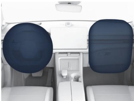
图示：正面安全气囊展开情形
