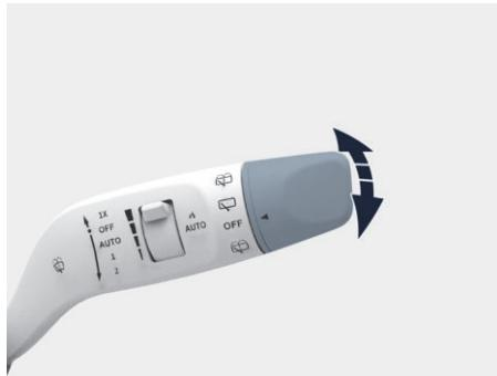
图示：旋转拨杆上的旋钮，开启/关闭后雨刮
