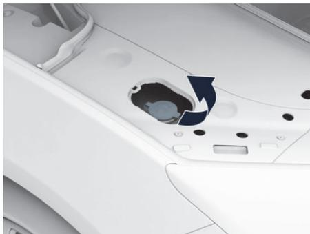
图示：洗涤剂注水口
