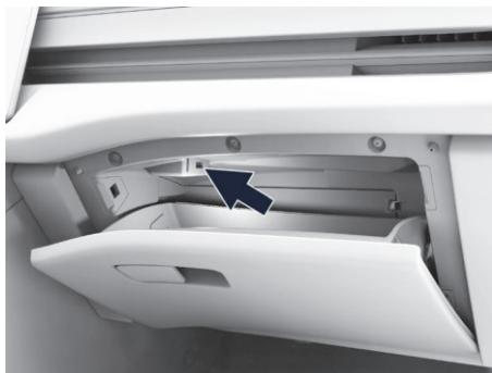
图示：手套箱内的USB接口位置
