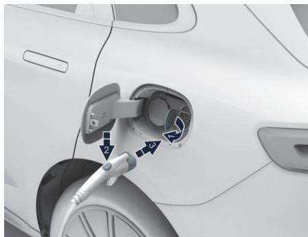
图示：放电枪插入充电口
