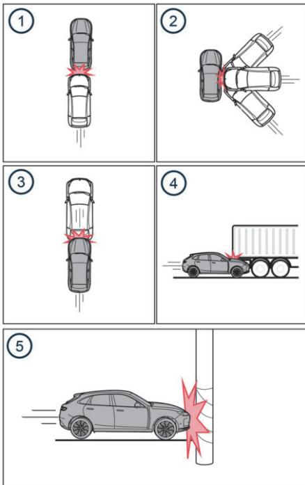
图示：安全气囊可能不会展开的情况举例，图中以灰色车辆指代本车。
