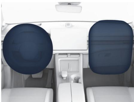
图示：正面安全气囊展开情形
