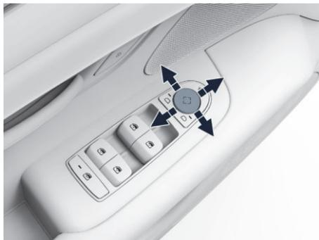
图示：外后视镜调节方向圆形按键
