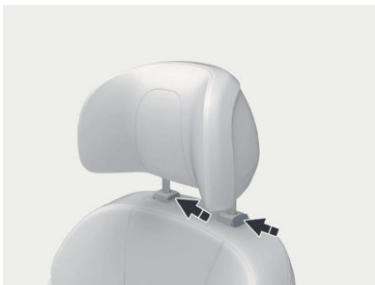
图示：拆卸副驾驶座椅头枕
