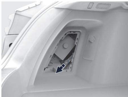
图示：充电枪应急解锁拉线
