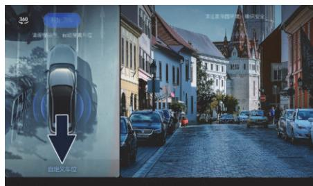
1. 开启APA后，驾驶员踩下制动踏板停止车辆后，可以点击屏幕下方的“自定义车位”，以切换到自选车位泊入模式。
