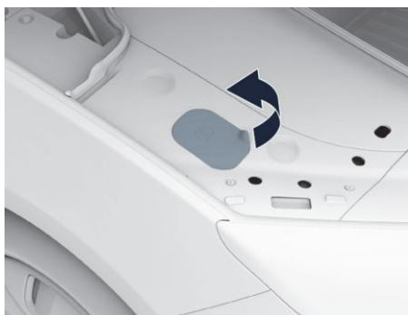
图示：洗涤液罐盖板
