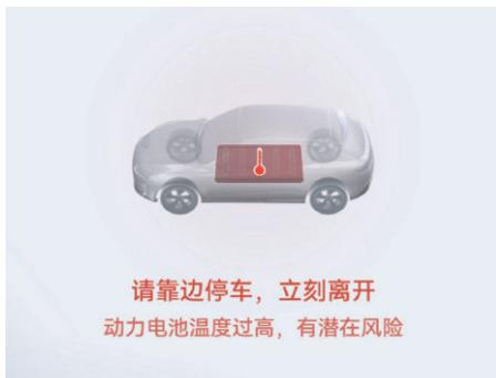
图示：仪表显示屏动力电池过温警示（不同版本存在差异，请以实车为准）
