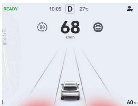
图示：盲点检测系统/并线辅助警示图标
