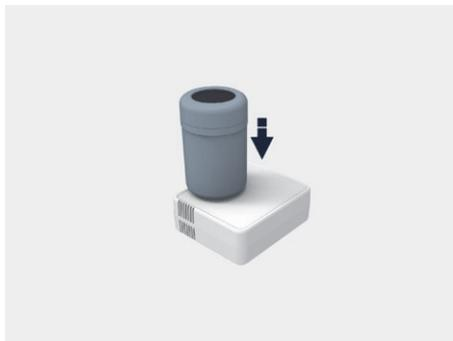
图示：安装补胎液罐
