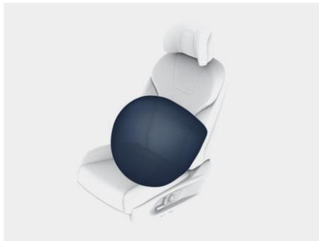
图示：前排座椅侧气囊展开情形
