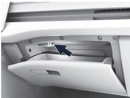
图示：手套箱内的USB接口位置
