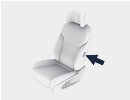
图示：前排座椅侧气囊位置
