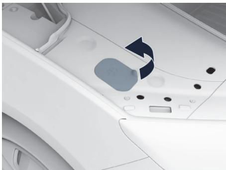
图示：洗涤剂罐盖板
