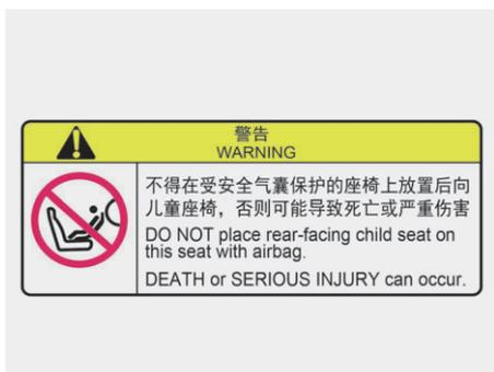
图示：乘客侧安全气囊警示图标
