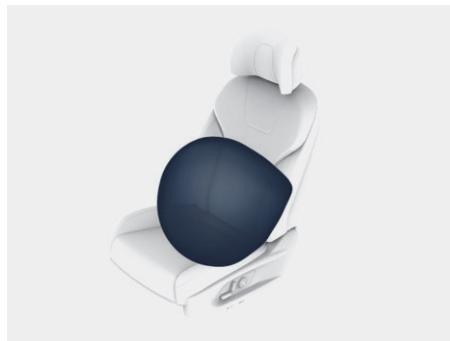
图示：前排座椅侧气囊展开情形
