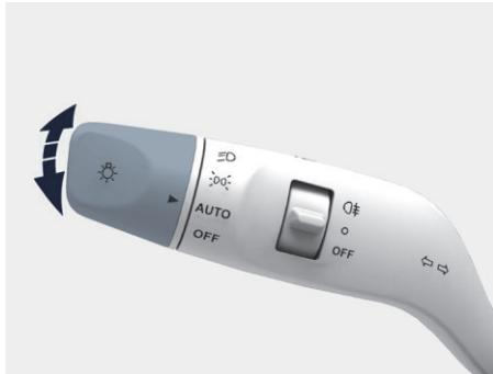
图示：旋转拨杆上的旋钮，调节外部照明类型
