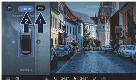
1. 开启 APA，踩住制动踏板，在车辆静止状态下点击右上角“泊入/泊出”切换到泊出模式（泊出模式时图标显示文字为泊入），选择泊出方向后，点击“开始泊出”，开启辅助泊出功能。
