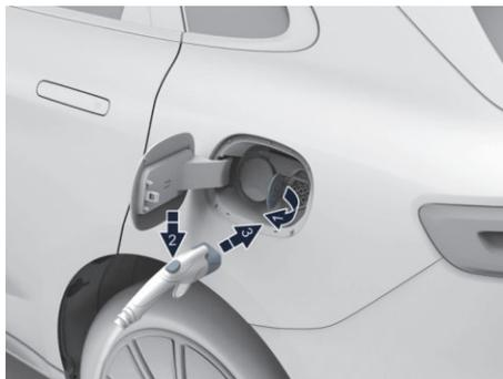
图示：放电枪插入充电口
