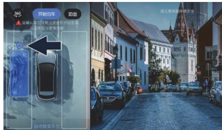
2. 点击“自定义车位”后，拖动车位框到合适位置可放置车位。目标位置空间大小不能小于视图中外侧虚线框大小。放置时，请注意观察环境，车位框不能放置在其它障碍物上。
