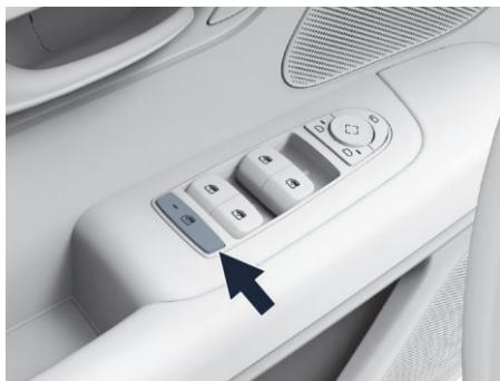
图示：车窗锁止开关
