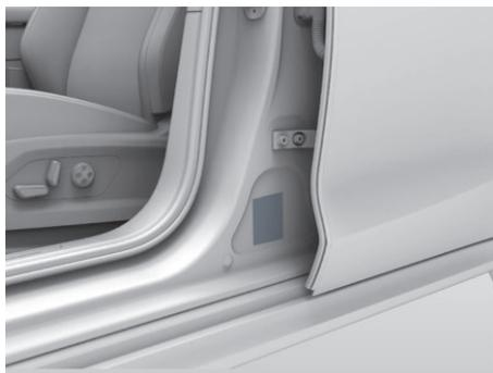
图示：胎压标签位于左侧B柱下方
