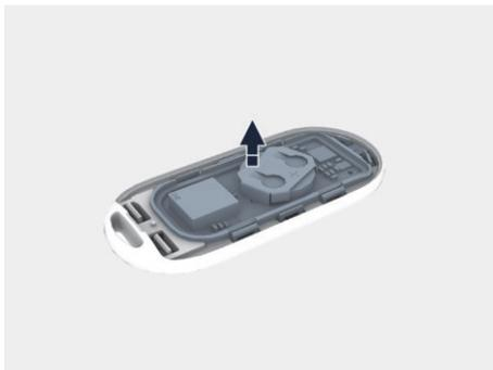
图示：取出遥控钥匙电路板
